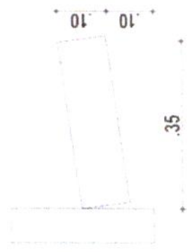
03 | DETALHE - MEIO FIO CONJUGADO COM SARJETA ESC. 1/10
